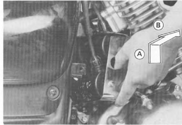
A. Das rechte Ende anheben. B. Die Spule nach rechts herausziehen.
