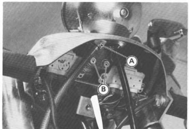
A. Oberes Ende der Tachometerwelle B. Schrauben für Tachometer
